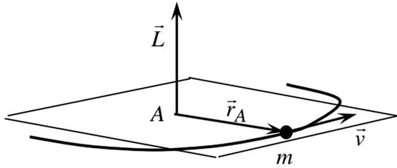
Para una partícula de masa  $m$  que se mueve con velocidad  $\vec{v}$  por una trayectoria con un radio de curvatura  $\vec{r}_A$ , el producto vectorial  $\vec{r}_A \times m\vec{v}$  es el vector momento angular  $\vec{L}$ . Es un vector siempre perpendicular al plano del movimiento
